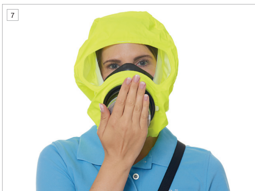
7 Prüfen Sie den Dichtsitz, indem Sie die Filteröffnung mit dem Handball verschließen und einatmen. Ist ein Luftzug spürbar, korrigieren Sie den Sitz der Haube.
