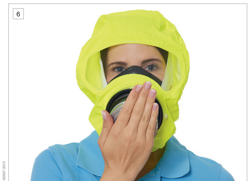
6 Prüfen Sie den Dichtsitz, indem Sie die Filteröffnung mit dem Handballen verschließen und einatmen. Ist ein Luftzug spürbar, korrigieren Sie den Sitz der Halbmaske.
